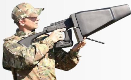
Le **PHISHAL** est un fusil anti-drone. Il interrompt la connexion entre le drone et la station de contrôle. Il aurait une portée effective allant jusqu'à 2 000 mètres et peut fonctionner sur des fréquences de 600 MHz à 6 000 MHz. Pishal pèse trois kilogrammes, ce qui le rend assez léger pour une utilisation par un seul opérateur. Il est également annoncé comme inoffensif pour l'opérateur. Il aurait, à ce jour, neutralisé plus d'une vingtaine de drones, notamment en Syrie.
