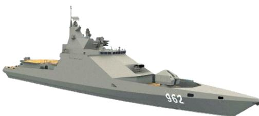
Le **PROJET 22350M** est une nouvelle classe de frégates prévue pour l'année 2027. Il est prévu qu'elles deviennent les bâtiments les plus puissants de la Marine russe (à l'exception du porte-avions). Le projet porte sur un navire avec un déplacement de 7 000 tonnes et une capacité de transporter jusqu'à 48 missiles de croisière Kalibr, Oniks et Tsirkon. En tout, 12 frégates de cette classe devraient être fabriquées.
