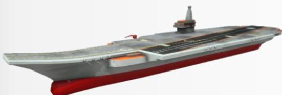
Le **PROJET 11430<sup>E</sup> / LAMANTIN** est un programme de porte-avions, dont le déplacement total est compris entre 80 et 90 000 tonnes. La longueur (350 m), la largeur (41m) de la coque et le tirant d'eau (12 m) du Lamantin sont également assez proches des indicateurs correspondants de l'Oulianovsk (porte-avions inachevé). La propulsion serait a priori nucléaire.
